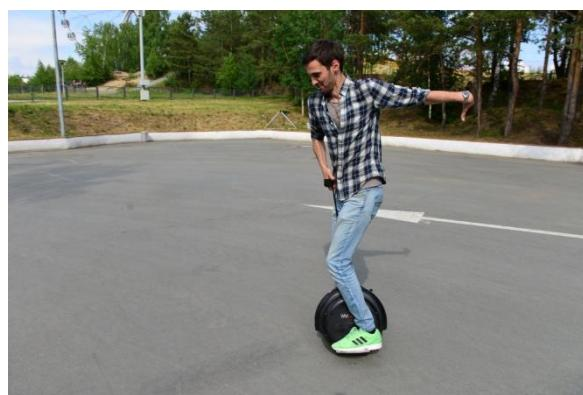
В свою очередь моноколесо - это электрический самобалансирующийся самокат (моноцикл) с одним колесом и расположенными по обе стороны от колеса подножками.
